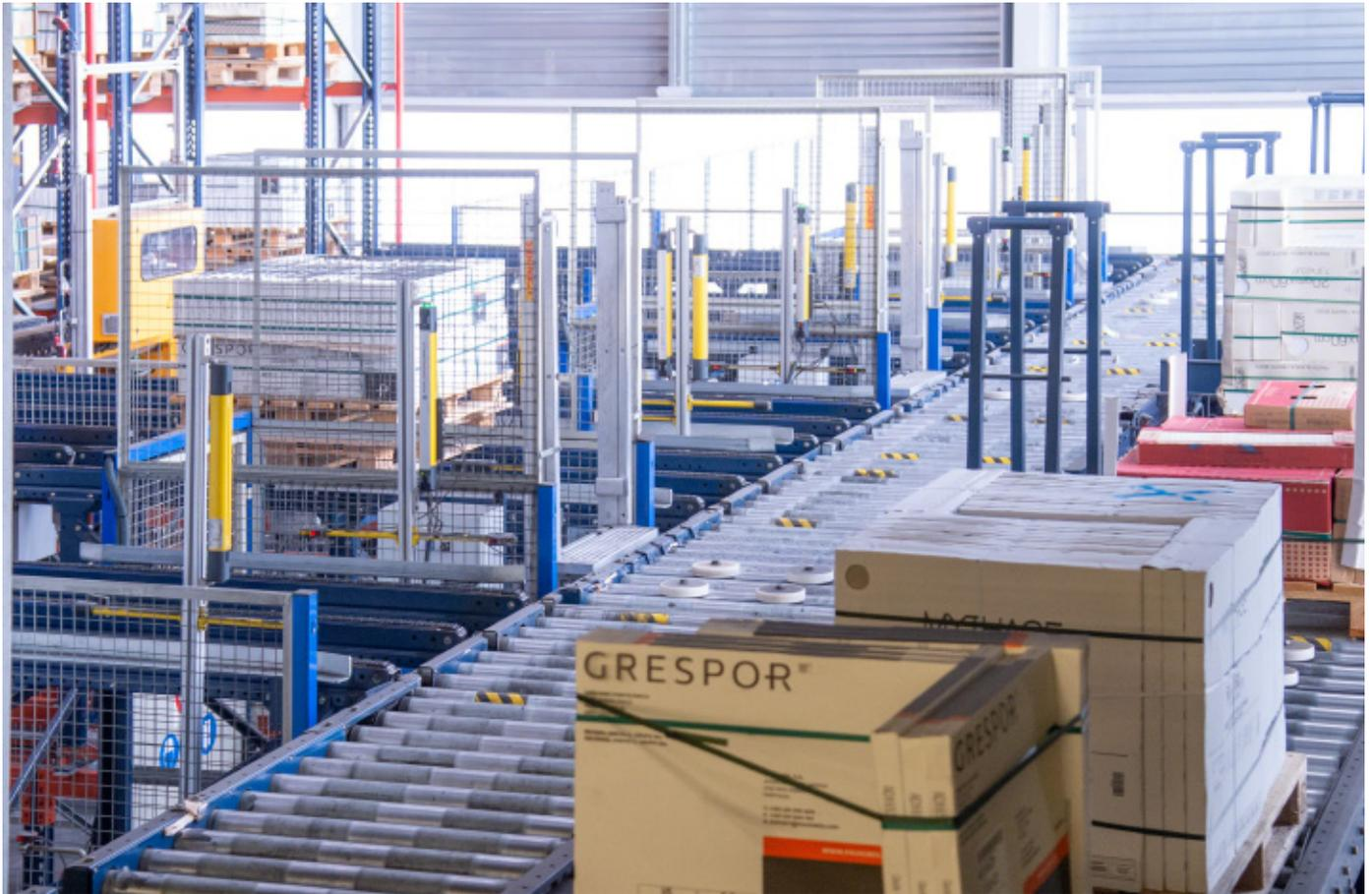
Le nouvel entrepôt de VM Matériaux est entièrement automatisé : trois transstockeurs insèrent et extraient les marchandises de leurs emplacements en toute autonomie. L'installation, d'une capacité supérieure à 5 700 palettes, se distingue par la longueur de ses allées de stockage : 95 mètres. Les
