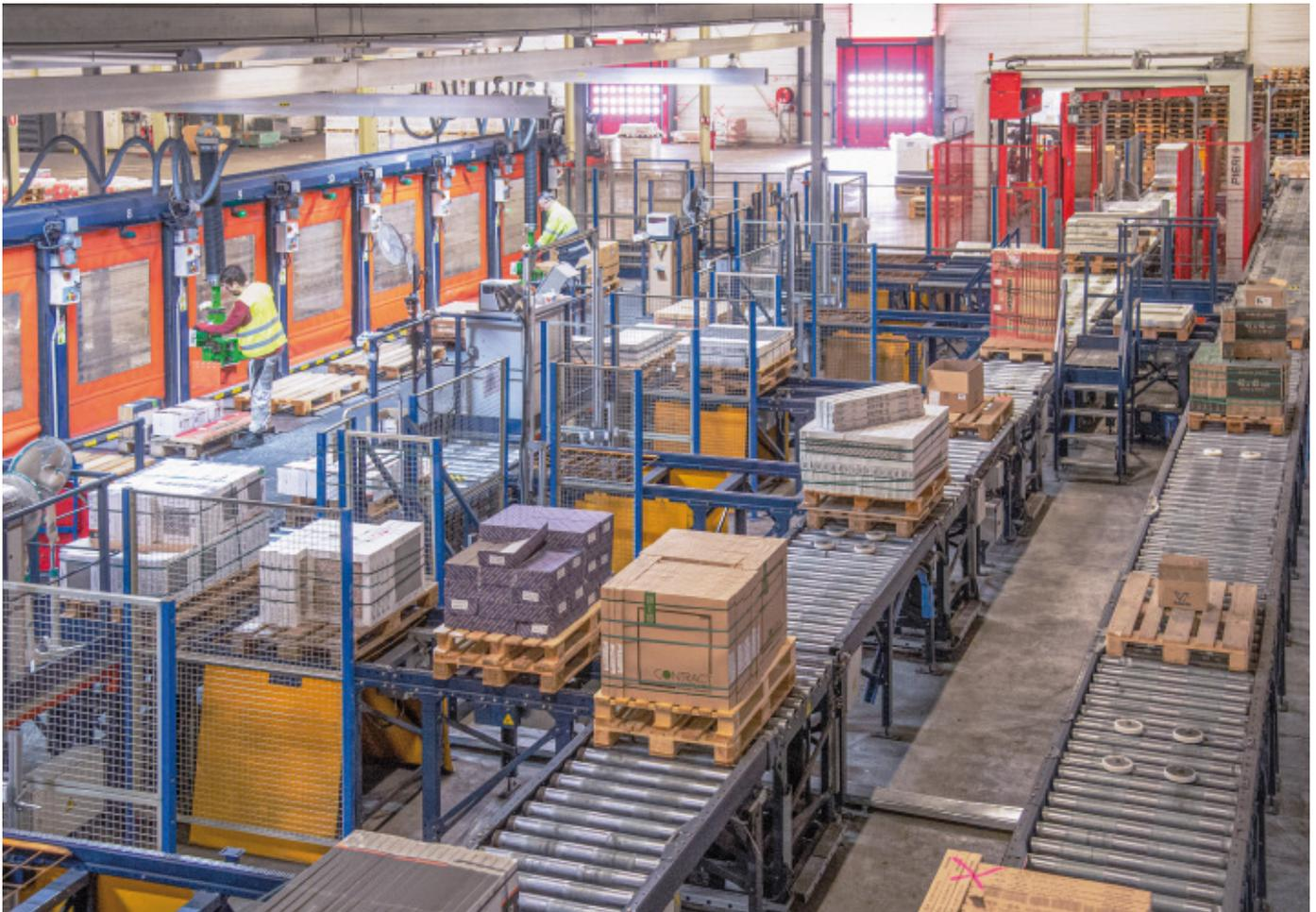
une zone de préparation des commandes en installant des convoyeurs, des navettes et des postes de picking équipés d'équipements de manutention pour faciliter le travail des opérateurs.
