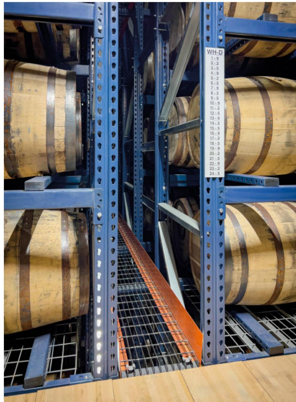
pacter les marchandises, les rayonnages ont une profondeur permettant d'accumuler jusqu'à 24 tonneaux de 250 kg.
